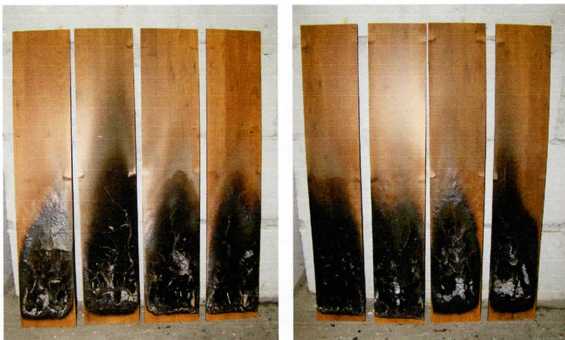
Рисунок 1 - Характерний вигляд зразків № 1-4 та № 5-8 фасадної HPL панелі (компакт-ламініат), виробництва CROWN DÉCOR PVT. LTD. (Індія), після випробувань з визначення групи горючості згідно з ДСТУ 8829:2019.
