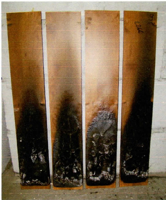
Рисунок 2 - Характерний вигляд зразків № 9-12 фасадної HPL панелі (компакт-ламініат), виробництва CROWN DÉCOR PVT. LTD. (Індія), після випробувань з визначення групи горючості згідно з ДСТУ 8829:2019.
